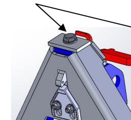
Zusätzliche Sicherung der Anbaugeräte
